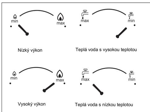
Otočením knoflíku voliče teploty, displej ohřivače zobrazuje nastavenou teplotu. Po cca 3 vteřinách se zobrazuje aktuální teplotu ohřivané vody.
